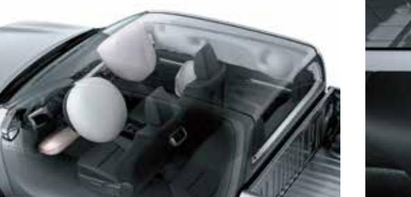
**أكياس الهواء:** سيارة هايلكس مجهزة بـ 8 أكياس هواي للسائق وكيس هواي SRS للراكب الأمامي وكيس هواي SRS للركبتين (مقعد السائق) وكيس هواي SRS على المقاعد الأمامية والخلفية.
